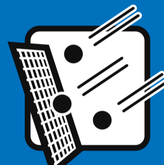
Test alla grandine (Sfere diam. 45-75 mm; velocità 30,7-37,5 m/s)
